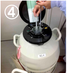
液体窒素素蒸気下に5分静置。その後、完全に凍結する。
